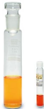
Die bei der Standardmethode und beim Küvetten-Test verwendete Chemikalienmenge im Vergleich
